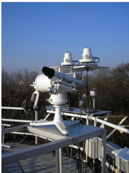
Figuur 1.17. Nieuwe installatie voor radiometrische metingen, met systeem voor het automatisch richten naar de zon.
