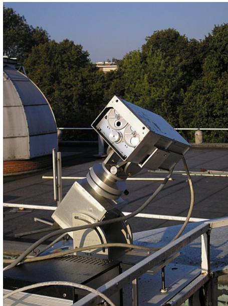
Figuur 1.20. Absolute radiometer CROM09 op het dak van de stralingstoren van het KMI.
