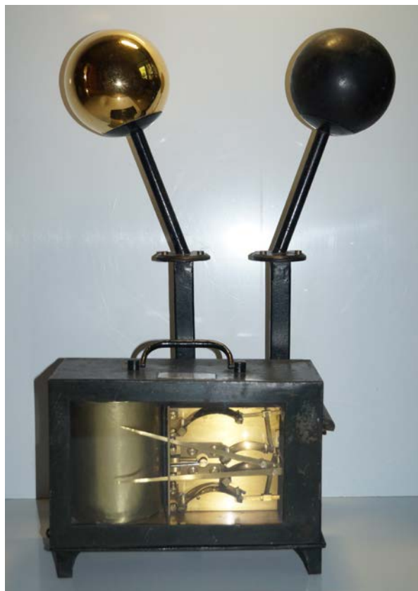
Actinometer/Actinograaf (een instrument om de (UV) stralingsintensiteit te meten), midden van de 19de eeuw, Jules Richard, Parijs, Koninklijk Meteorologisch Instituut
