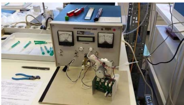
De ozonsonde testeenheid, die gebruikt wordt voor het voorbereiden, testen en karakteriseren van de ozonsondes, met op de voorgrond de ozonsonde (grijze pump vooraan, de witte cellen die de vloeistoffen bevatten erachter).
